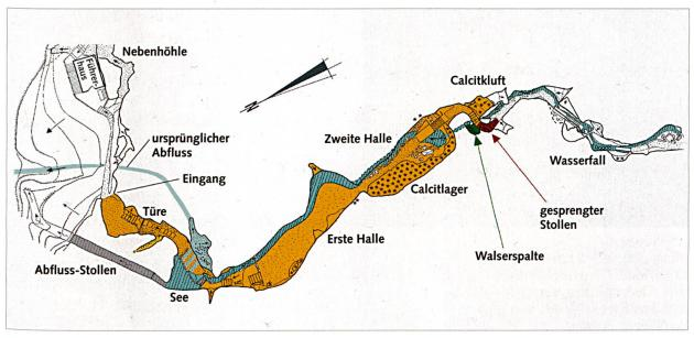
Abbildung 3: Plan des anfänglich bekannten Teils der Kristallhöhle Kobelwald (gelb) mit der engen Walserspalte (grün) und mit dem in den Felsen gesprengten Stollen (rot) (Zeichnung: Hans Stünzi).
