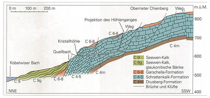
Abbildung 9: Geologisches Profil des Chienberges, mit eingezeichneter Kristallhöhle Kobelwald (nach EUGSTER ET AL. 1960).
