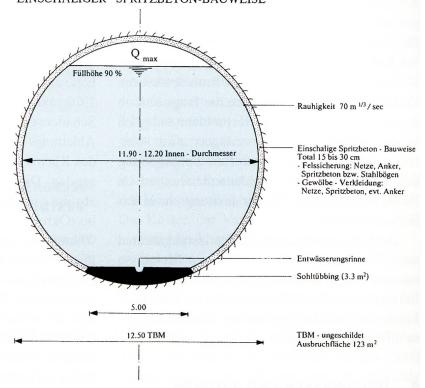
Abb. 4. Normalprofil des Alviertunnels mit einschaligem Ausbau im standfesten Fels (Quintnerkalk).
