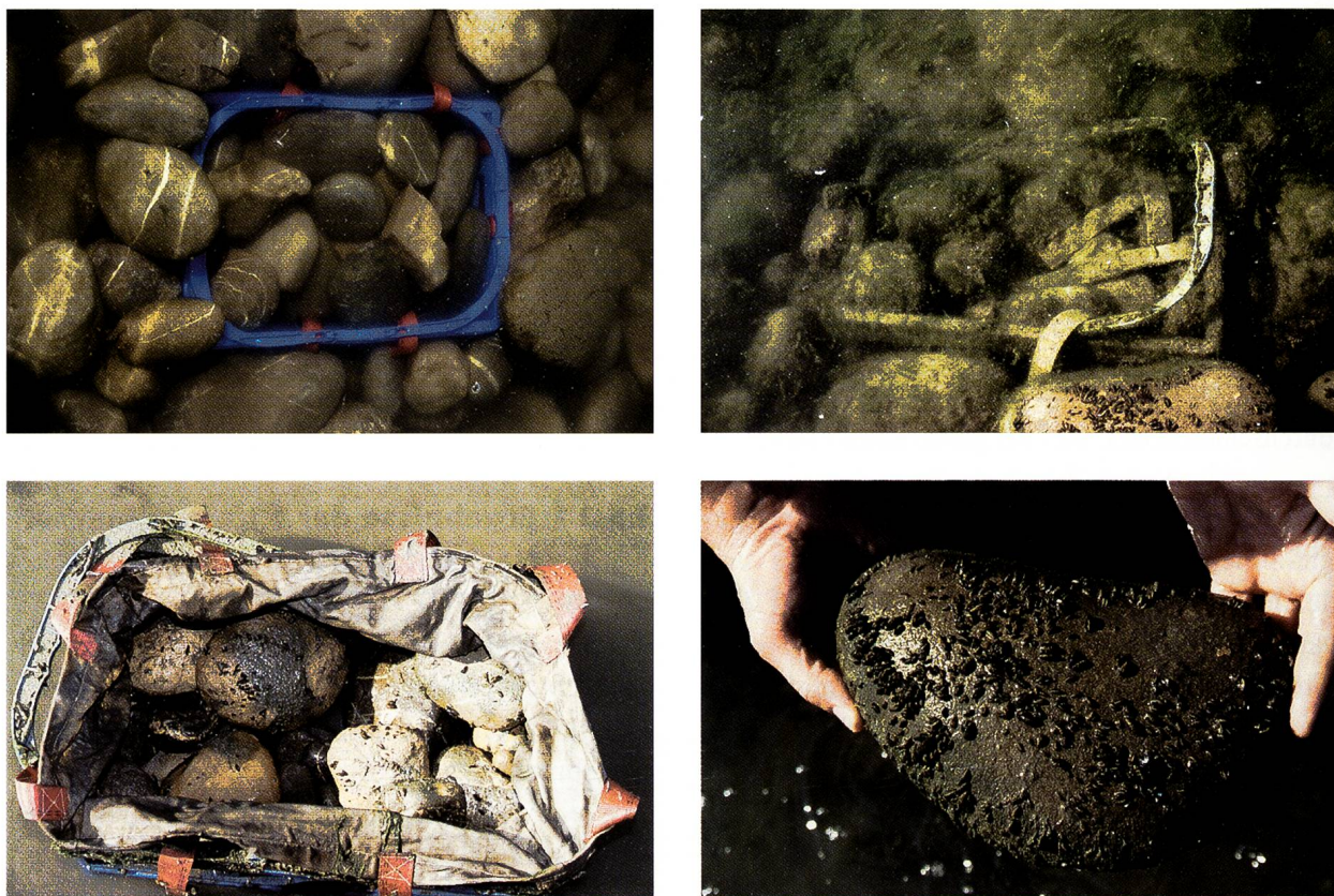
Abb. 11. Oben links: frisch eingebrachter Versuchskorb. Oben rechts: Versuchskorb 4 Monate später. Unten links: geborgener Versuchskorb mit hochgezogenem Netzbeutel. Unten rechts: Besiedlung der Böschungsfusswacken mit Benthosorganismen.
