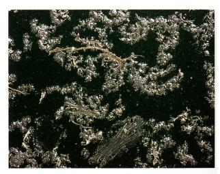
Abb. 6. Ausgeschiedene CaCO<sub>3</sub>-Kristalle an Pflanzenmaterial angelagert.
