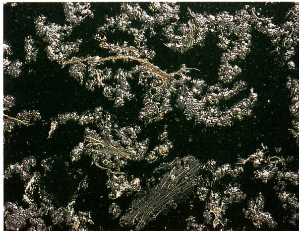
Abb. 6. Ausgeschiedene CaCO 3 -Kristalle an Pflanzenmaterial angelagert.
