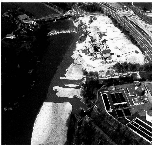
Abb. 4. Sunk, Schwall und Trübung durch Feinsedimente infolge intermittierendem Kraftwerksbetrieb aus der Landquart. (Foto: P. Rey).
