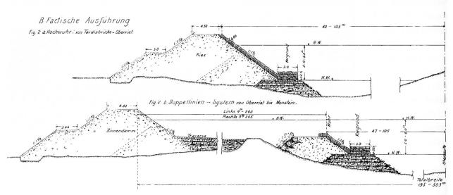
Abb. 1.4. Dammtypen für die St. Galler Rheinkorrektion, oben Hochwuhr, unten Doppellinien-System nach J. Wey, 1909.
