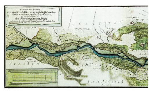
Abb. 1.3. Schupfwuhren und Hinterdämme am Rhein bei Haag (Fliessrichtung von links nach rechts) aus einem Plan von H.C. Römer, 1700.
