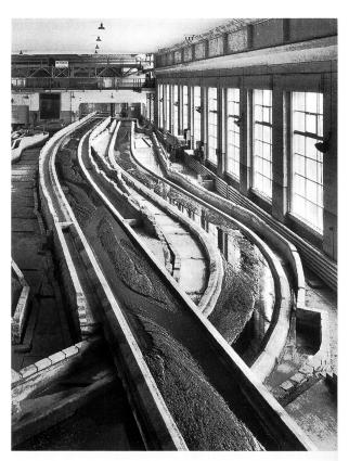
Abb. 1.7. Modelle des Mittelgerinnes des Rheins in der Versuchsanstalt für Wasserbau (VAW) der ETH Zürich, 1938 (Foto VAW).
