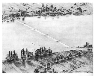
Abb. 3.2. Zusatzprojekt von Bächtold 1973 mit überflutbarem Schlauchwehr zwischen Öhningen-Eschenz und Schiffsschleuse.
