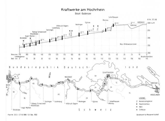
Abb. 2. Der Rhein zwischen Konstanz und Basel, unten topografisch, darüber im Längsschnitt. Die Kraftwerke verwandelten den Fluss in eine Abfolge von Staustufen; lediglich in vier Abschnitten fliesst der Rhein ungestaut: unterhalb des Untersees, zwischen Schaffhausen und Rheinfall, oberhalb der Thurmündung und unterhalb des Kraftwerks Reckingen. Quelle: Bundesamt für Wasserwirtschaft.
