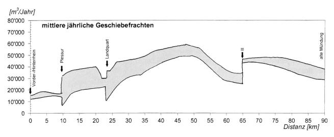
Abb. 4. Mittlere jährliche Geschiebefrachten im Alpenrhein für die Periode 1974–1995. Resultat aus der Simulation mit zwei verschiedenen numerischen Modellen (ZARN und HUNZIKER, 2001).
