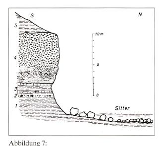
Profil des Malmkalk-Blockhorizonts (Bernhardzell). 1 Mergel, 2 Blockhorizont, 3 Mergel und Mergelkalk, 4 Nagelfluh der Hörnlischüttung, 5 Mergel. Aus: HOFMANN (1967).
