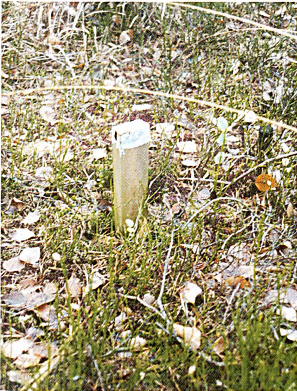
Abbildung 2: Markierungspfahl der Eckpunkte des Kartierungsnetzes.
