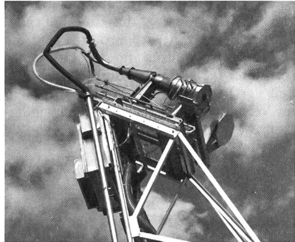
Abb. 3: Reaktor mit gekühlten Schutzschildern
