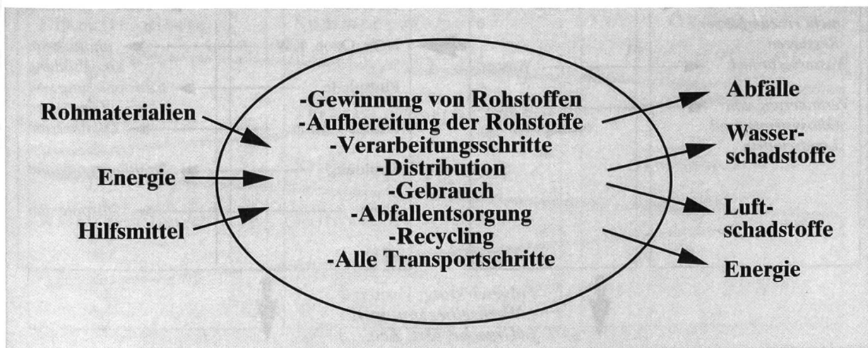
Abb. 3: Stoff- und Energiebilanz als Grundlage eines Ökobilanzinventars
