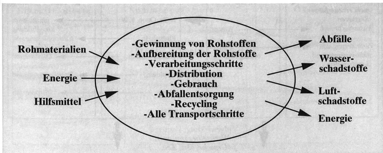
Abb. 3: Stoff- und Energiebilanz als Grundlage eines Ökobilanzinventars
