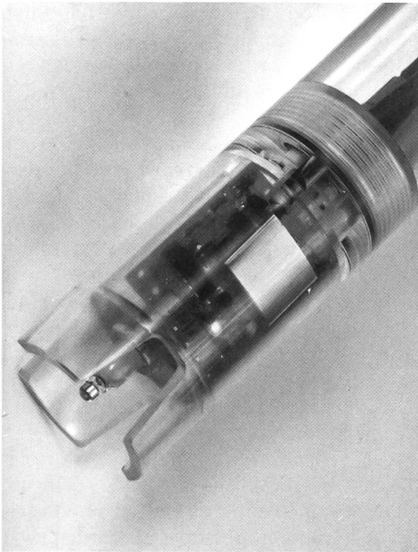
Abb. 5: Redox-Sonde, System Züllig mit Einstabelelektrode und integriertem Vorverstärker
