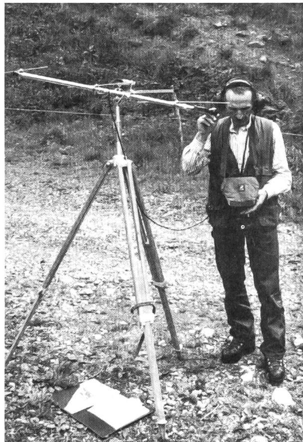
Abb. 3: Telemetrieausrüstung empfängerseits (Antenne auf Stativ, Empfänger an Gurte in Etui, Kopfhörer).
