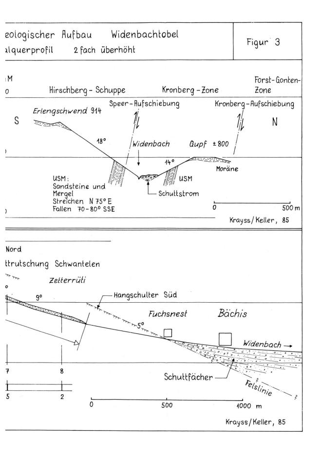
— derart plastisch, dass sie bereits bei einem Oberflächengefälle von 10° in Bewegung geraten kann. Das Vorrücken der Schuttmassen erfolgt deshalb bei den vorliegenden Verhältnissen der Witterung entsprechend schubweise.
