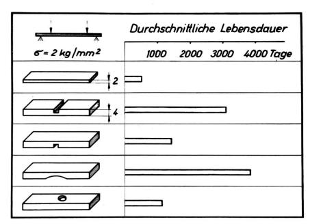
Bild 3 Lebensdauer von Stäben aus Phenoplast-Preßmasse. Einfluß unterschiedlicher Kerbung bei Lagerung im Freien unter einer Biegespannung von 2 kg/mm². (H. WEIDMANN AG.)
