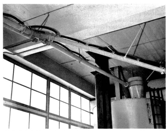
$Abb.\,11,\,12\quad \hbox{Rohrf\"{u}hrung mit Rohrweiche und Verzweigung auf zwei verschiedene Silos.}$
