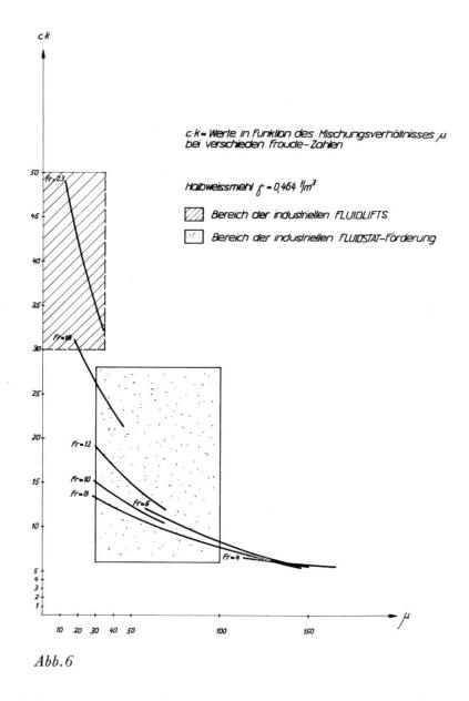
Die Minima ergeben die optimalen Froudeschen Zahlen. Deutlich ist bei zunehmendem Mischungsverhältnis eine leichte Verschiebung der optimalen Froudeschen Zahlen gegen kleinere Werte feststellbar.
