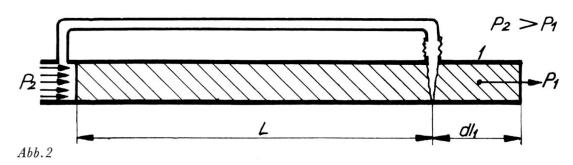
Ist einmal das Rohrstück dl<sub>1</sub> entleert (Abb. 3), so ist es möglich, durch Verschieben des Bypasses in gleicher Weise den zweiten Abschnitt dl<sub>2</sub>, und sinngemäß dl<sub>3</sub>, dl<sub>4</sub>÷ dl<sub>x</sub> zu entleeren.
