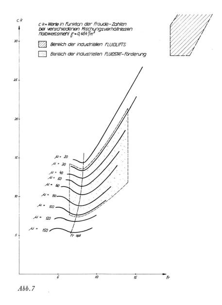
c · K-Werte bei Froude optimal über  $\mu$  für Perborat, Hartweizengrieß, Na-Tripoliphosphat, Halbweißmehl und mehlige Tonerde aufgetragen sind.
