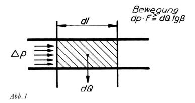
leitung gegen das Ende der Förderleitung anzusetzen, wo der Druck p<sub>2</sub> ausreicht, die Gutsäule der Länge dl<sub>1</sub> auszustoßen. Dazu ist nur eine geringe Luftmenge erforderlich, und die Vorgänge lassen sich etwas vereinfacht als statische Druckübertragung ansprechen. (Daher der Name Fluidstat-System.)
