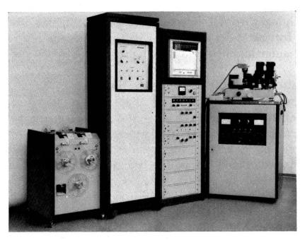
Bild 4 Meßplatz für Kristalluntersuchung. Rechts ist das Gerät für die Stromversorgung der Röntgenröhre zu sehen, darauf das Weißenberg-Goniometer mit Röntgenröhre und Zählrohr. In Bildmitte: Zähler und Linienschreiber. Der anschließende Schrank enthält die elektronische Steuer- und Registrieranlage. Links: Lochstreifenstanzer und -leser für Ein- und Ausgabe.
