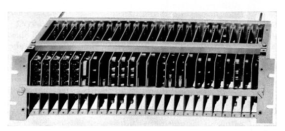
Bild 2 Elektronikwanne mit 24 steckbaren Schaltungskarten.
