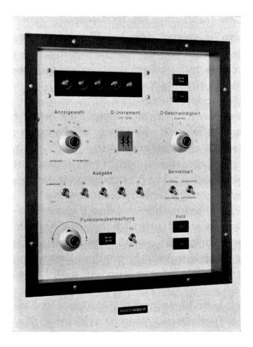
Bild 1 Fronttafel eines Spezialzweckrechners, individuell nach Kundenwunsch hergestellt.
