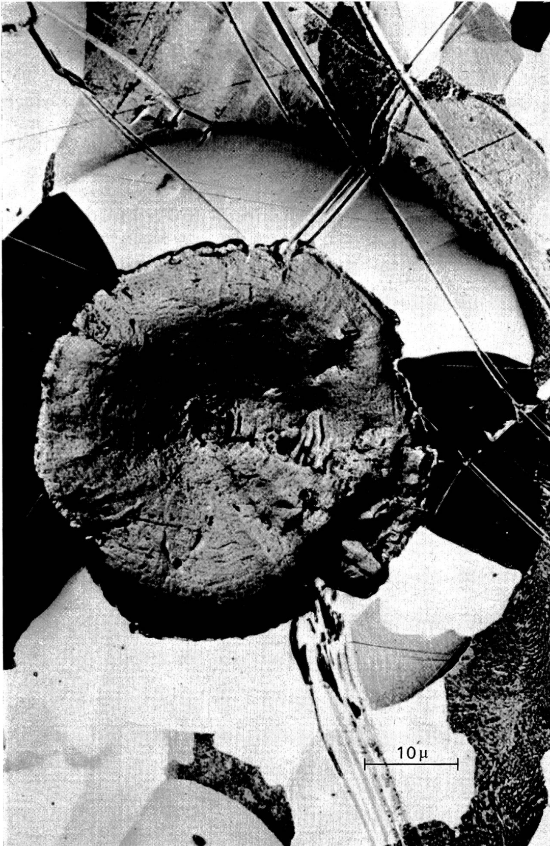
Abb. 5 Photoemissionsaufnahme eines Sphärogusses. In der Mitte der Sphärolit, darum herum die Ferritzone, außen Perlit. Vergrößerung 1800 \times .
