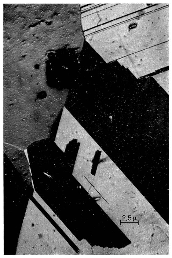
Abb.~9 Photoemissionsaufnahme einer Kupferoberfläche. Das Objekt wurde im Mikroskop bei 800° C rekristallisiert und nach Abkühlung auf 200° C aufgenommen. Vergrößerung  $4800\times$ .
