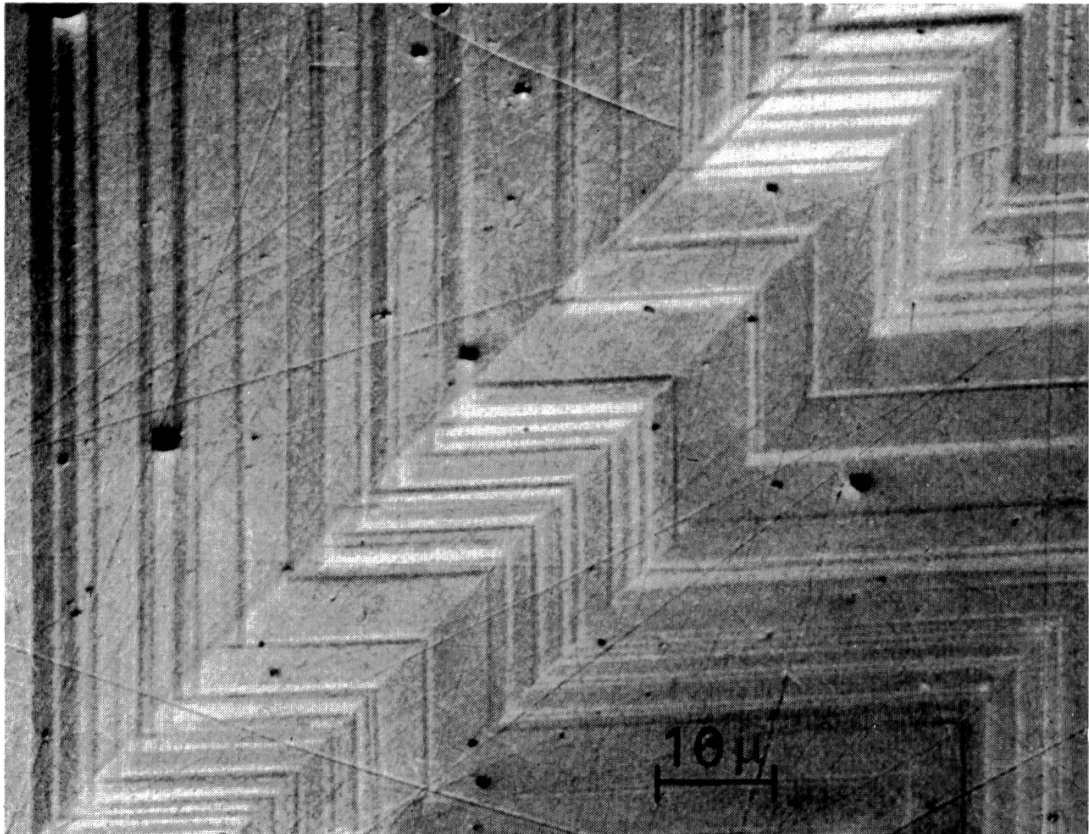
Abb. 14 Photoemissionsbild von ferroelektrischen Domänen in einem \text{WO}_3 -Kristall. Vergrößerung 1200\times .
