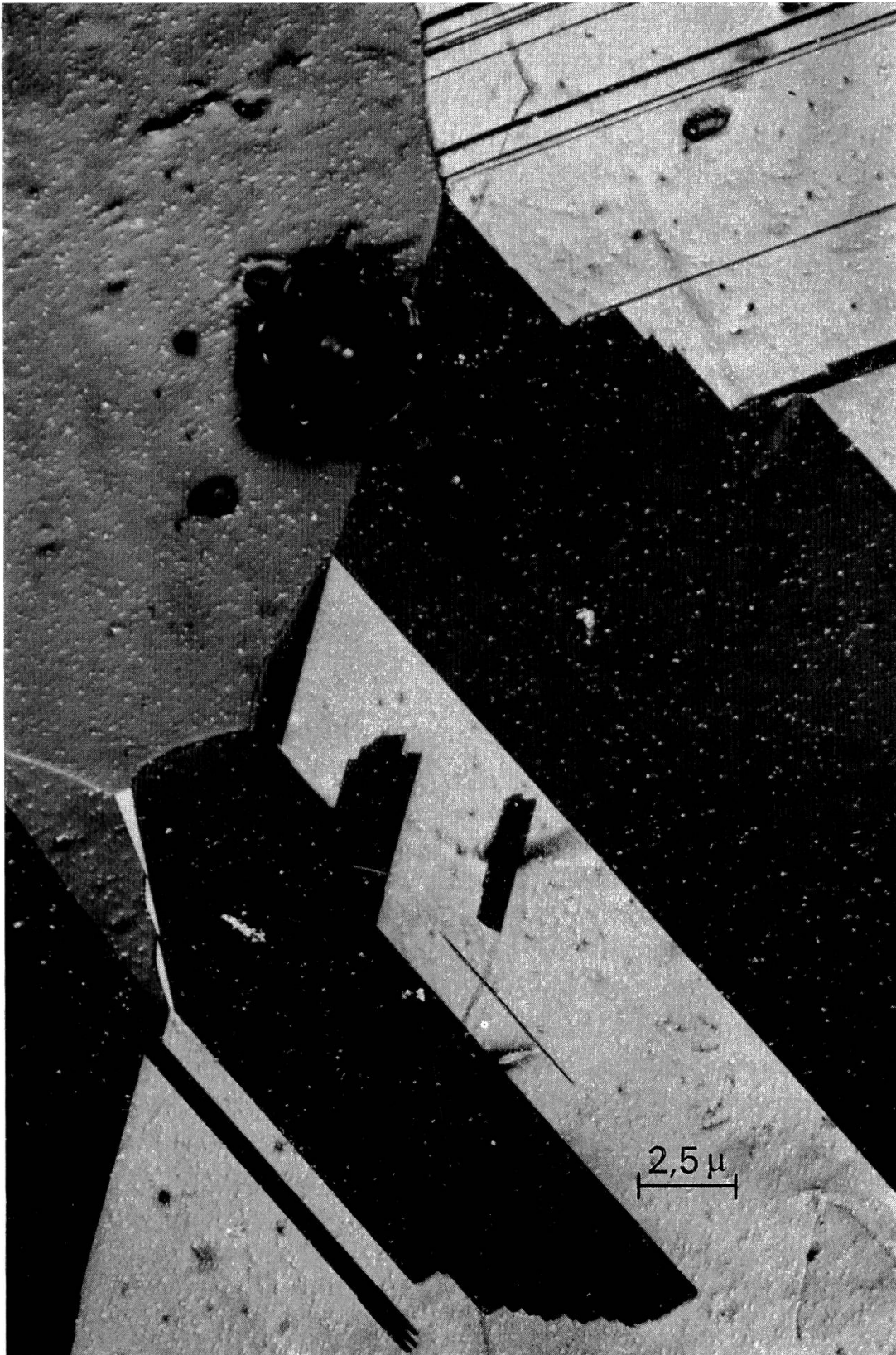
Abb. 9 Photoemissionsaufnahme einer Kupferoberfläche. Das Objekt wurde im Mikroskop bei 800° C rekristallisiert und nach Abkühlung auf 200° C aufgenommen. Vergrößerung 4800×.
