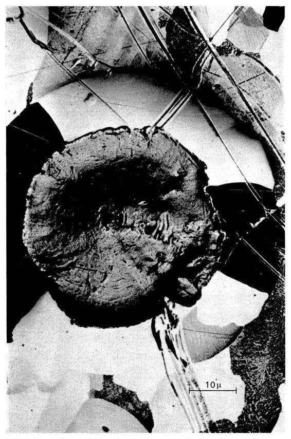
Abb.~5~ Photoemissionsaufnahme eines Sphärogusses. In der Mitte der Sphärolit, darum herum die Ferritzone, außen Perlit. Vergrößerung  $1800\times.$
