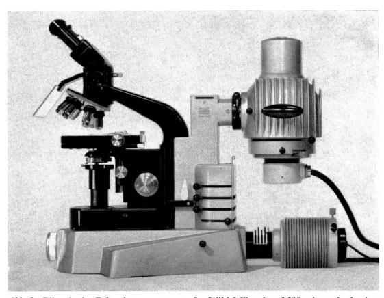
Abb. 2 Biluminaler Beleuchtungsuntersatz für Wild-Mikroskop M20 mit wechselweiser oder gleichzeitiger Verwendung von Quecksilber-Höchstdruck- und Quarzjodlampe für Blaulicht- und UV-Fluoreszenz nebst Hellfeld und Phasenkontrast.
