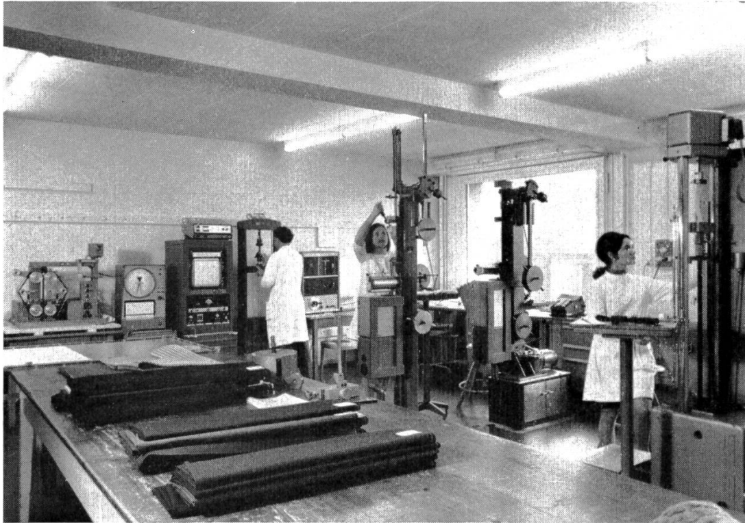
Klimatisierter Prüfraum für physikalische Garn- und Gewebeuntersuchungen.
