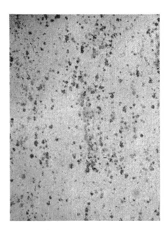
Fig. 1 Zeltstoff mit grauen und grauschwarzen Schimmelpilzflecken.
