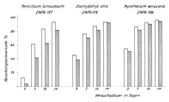
Fig. 3 Fördernde Wirkung des Lichteinflusses auf den Zelluloseabbau von Baumwollgewebe durch Kulturen von Penicillium funiculosum, Stachybotrys atra und Myrothecium verrucaria (dargestellt als Reißfestigkeitsverluste; leere Säulen = belichtet; schraffierte Säulen = dunkel gehalten).
