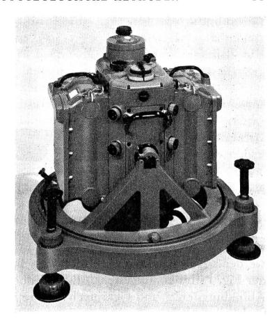
Fig. 2 Moderne Fliegerkammer für Senkrechtaufnahmen
