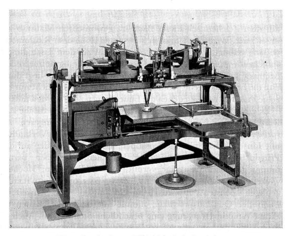
Fig. 4. Stereokartiergerät Wild A 6 für Senkrechtaufnahmen
