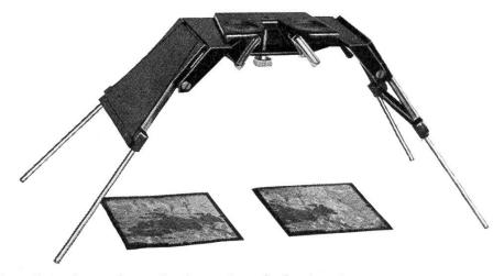
Fig. 3. Klapp-Spiegelstereoskop mit eingepaßten Senkrechtaufnahmen im Format  $13 \times 13$  cm<sup>2</sup>.
