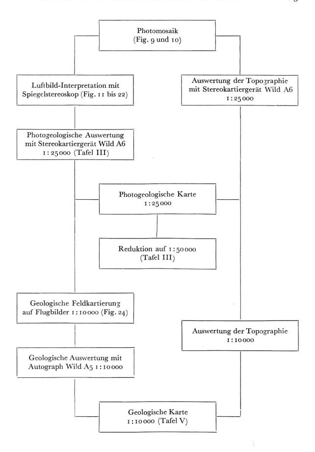
Fig. 8. Schematische Darstellung der photogeologischen Arbeitsweise
