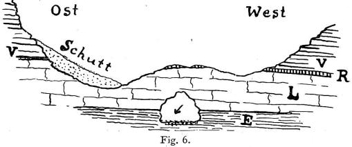
Schematisches Querprofil durch die Kärpfbrücke von J. Oberholzer. V = Verrucano. R = Röthidolomit. L = Lochseitenkalk. E = eocäner Flysch.
