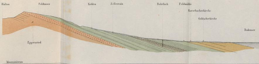
III. Profil des Bohrloches bei Rorschach
