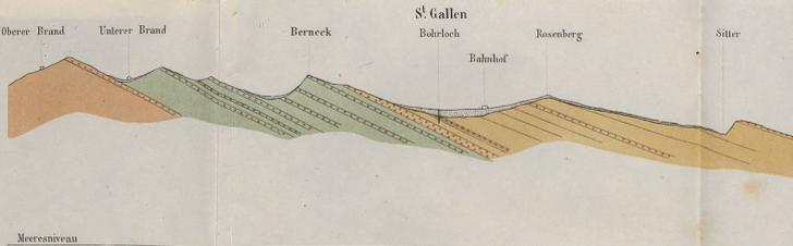
IV. Profil des Bohrloches bei S<sup>t</sup> Gallen
