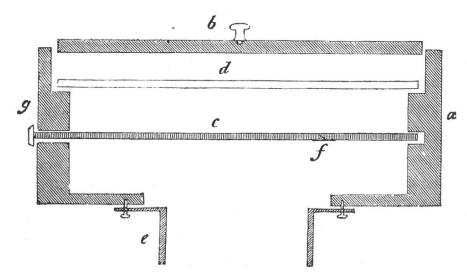
a g Kasten, b Deckel, c Schieber, d Glastafel, e Einsatzstück für in das Mikroskop, f Charnier.
