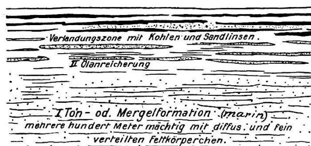
Fig. 2. Erdöl- und erdgas-führende Antiklinale nach der Faltung der Schichten und nach Beginn des Abtragungsvorganges.
