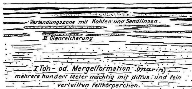
Fig. 1. Schichtablagerungen nahe einer Flachmeerküste z. B. am Rande einer grossen Meerbucht mit allmählicher Verlandung.
