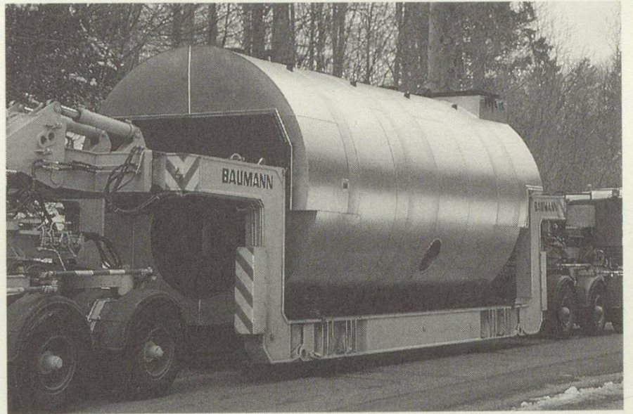
Anlieferung der Heizkessel auf Tiefgang-Lastwagen im März 1986
