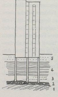
Der «Pfahlbau» der neuen «Chirurgie» (Pfähle über 20 m!)
