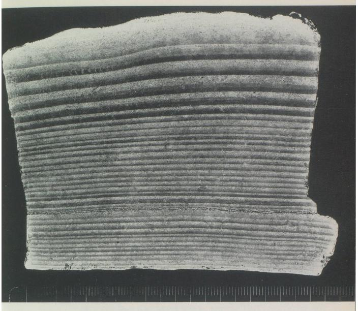
Bänderton aus dem glazialen Stausee Aufnahme der Versuchsanstalt für Wasserbau und Erdbau ETH
