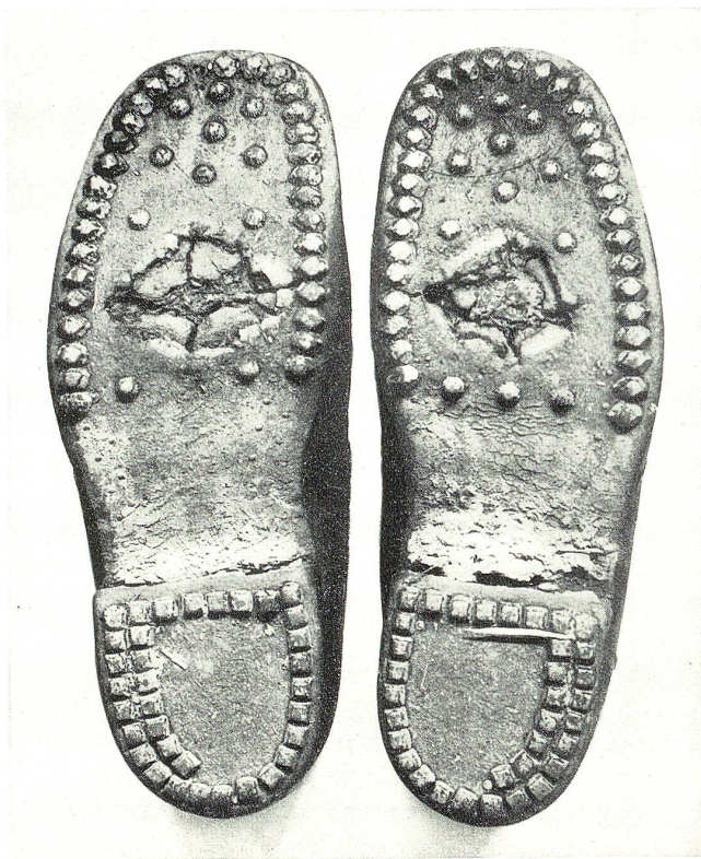
Sohlenverbrennung durch Dampfheizung, Lagerfeuer etc., da Leder sehr hitzeempfindlich ist und schon bei 60° C. im feuchten Zustande durch Hitze zerstört wird.
