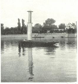
Erstes Bodensee-Rotorboot des Herrn Vogt-Wüthrich in Firma Vogt-Gut, A.-G., Arbon.
