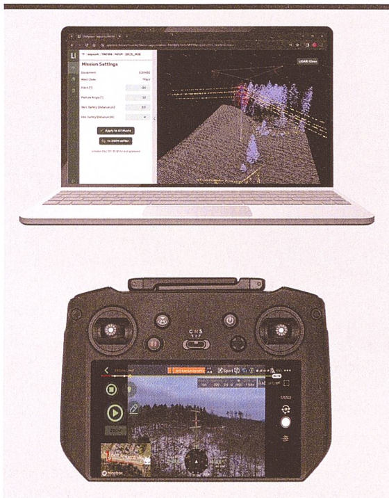
Bild 3 LINIApower für die Generierung von Flugmustern (oben); LINIAair Drohnensoftware für die automatisierte Datenaufnahme (unten).
