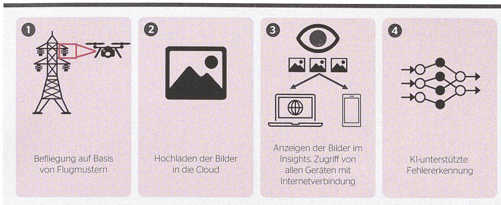
Bild 1 Prozess der Drohnenbefliegung zur Zustandsaufnahme.
