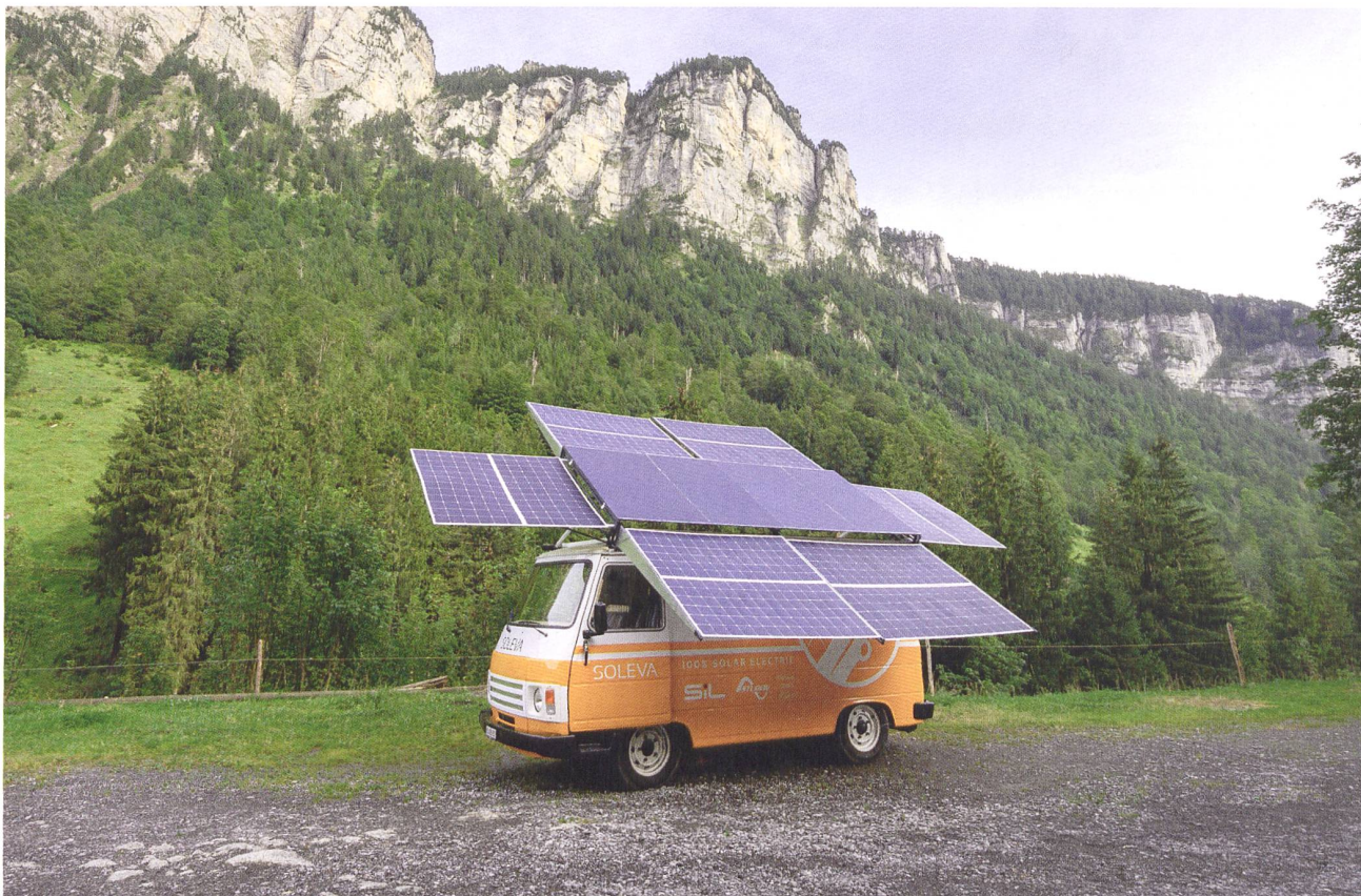
À l'arrêt, les panneaux solaires du van sont déployés et inclinés pour favoriser la production PV.
