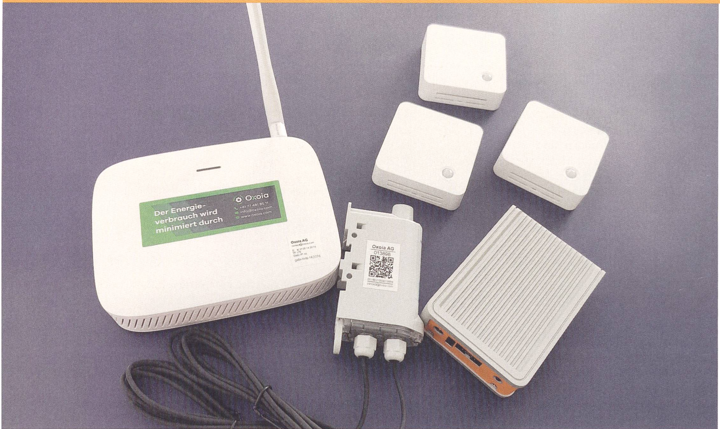
Die Plattform: LoRa-Infrastruktur, Gateways und Optimierungsplattform.
