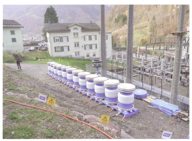
Kabelprüfung an einem 110-kV-Kabelsystem.
