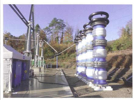
$\textbf{Bild 1} \ \ \text{Beispiel einer Kabelpr\"ufung durch die FKH an einem 380-kV-Kabelystem}.$
