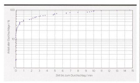
**Bild 3** Relative kumulierte Häufigkeit, dass ein Durchschlag nach n Minuten auftrat. 100 % entspricht dem Total von 53 Durchschlägen, bei welchen die Durchschlagszeit bekannt ist.
