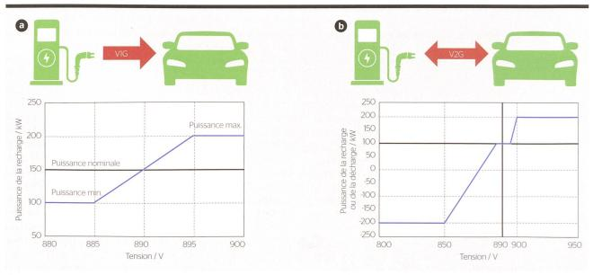
Figure 5 Paramétrage du système de gestion de l'énergie basé sur une fonction « droop control » : a) pour la recharge intelligente (V1G), et b) pour la recharge bidirectionnelle (V2G).
