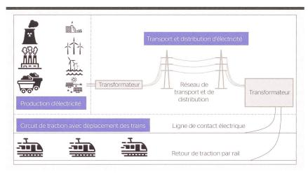
Figure 1 Schéma de l'infrastructure électrique ferroviaire.
