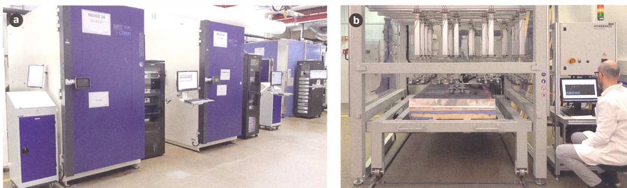
Figure 3 Le laboratoire de test et de caractérisation des modules photovoltaïques du CSEM dispose de divers systèmes de tests, dont a) des chambres climatiques, et b) des installations permettant de réaliser des tests mécaniques.
