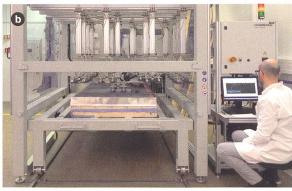
Figure 3 Le laboratoire de test et de caractérisation des modules photovoltaïques du CSEM dispose de divers systèmes de tests, dont a) des chambres climatiques, et b) des installations permettant de réaliser des tests mécaniques.
