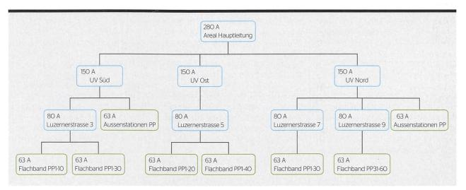
Im Smart-Me MLM kann die elektrische Installation im Gebäude oder im Areal in einer intuitiven Oberfläche nachgezeichnet werden.
