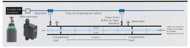
**Figure 4** Selon les indications du fabricant, les câbles à air comprimé ne devraient présenter aucune perte de pression pendant leur durée de vie de 40 ans. Il peut toutefois arriver qu'il faille rajouter de l'air comprimé après des dommages ou des travaux de révision: les lignes à air comprimé sont donc équipées d'une alimentation en gaz à partir de bouteilles d'air comprimé.
