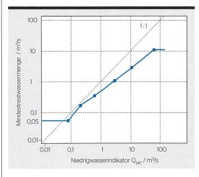
**Bild 2** Die in Artikel 31 Absatz 1 des Gewässerschutzgesetzes definierten Mindestrestwassermengen in Abhängigkeit des Niedrigwasserindikators Q<sub>347</sub> (logarithmierte Achsenskalierung).
