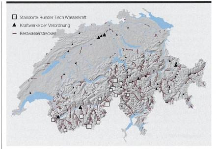
**Bild 1** Die durch die Wasserkraft bedingten Restwasserstrecken [7]; die 44 Kraftwerke, die von der Verordnung zur befristeten Erhöhung der Stromproduktion durch reduzierte Restwassermengen betroffenen waren; und die vom runden Tisch Wasserkraft ausgeschiedenen 16 Standorte.
