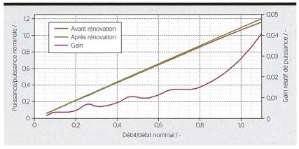
**Figure 2** Illustration du potentiel d'amélioration des performances dans le cas d'un remplacement de la roue: le gain de production lié à l'amélioration du rendement peut atteindre quelques pourcents.
