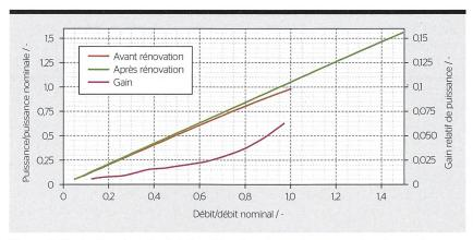
**Figure 4** Illustration du potentiel d'amélioration des performances dans le cas d'un remplacement complet du groupe: le gain de performance lié à l'amélioration du rendement et l'extension du domaine de fonctionnement offrent plus de flexibilité.
