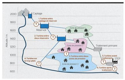
**Figure 2** Types de sites étudiés dans les études régionales sur les réseaux existants. Les sites 1 à 4 se trouvent sur des réseaux d'eau potable ou d'irrigation, les sites 5 et 6 sur des réseaux d'eaux usées.
