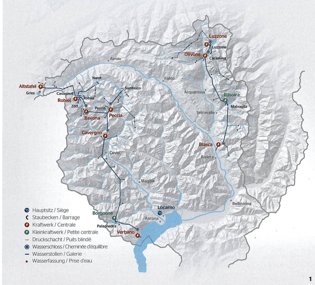
**1** Das System der Maggiakraftwerke (links) verfügt über 21 Turbinen und 6 Pumpen und nutzt ein Gefälle von rund 2200 m. Die installierte Leistung beträgt 670 MW. Im Bleniotal sind 8 Turbinen mit total 560 MW installiert.
