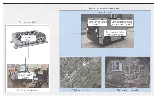
Figure 1 Architecture de simulation avec l'utilisation du logiciel Carla.
