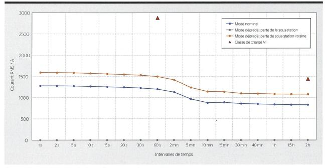
Figure 4 Exemple de courbes de charge d'une sous-station.
