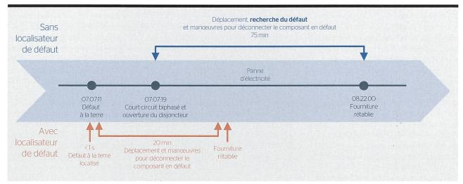
Figure 3 Réduction potentielle de la durée de la panne d'électricité grâce au localisateur de défaut de Zaphiro, lors d'un défaut sur le réseau des SIL.
