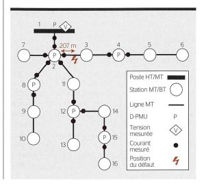
**Figure 2** Artère MT des SIL avec l'emplacement des D-PMU et du défaut.
