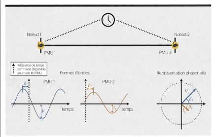
Figure 1 Phaseurs synchronisés générés par des PMU.
