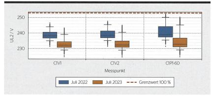
**Bild 2** Spannungen in zwei Verteilkabinen (C1V1 und C1V2) und bei einer PV-Anlage (C1P1-60) im Juli 2022 (blau) und im Juli 2023 (orange). Die Minimalwerte und der Median sanken durch eine Anpassung der Trafostufe um rund 6 V. Der Maximalwert nahm nur etwa um 3 V ab, weil zwischenzeitlich neue PV-Anlagen angeschlossen wurden und weil gleichzeitig eine Blindleistungsregelung falsch eingestellt war.
