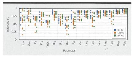
**Bild 1** Übersicht der gemessenen Qualitätsreserven in pu (per unit) unter Anwendung der heutigen Anschlussregeln. Erfasst wurden die Reserven in acht Trafostationen (TS), siebzehn Verteilkabinen (VK) und bei neun Hausanschlüssen (HA).
