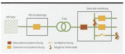
**Bild 5** Sekundärschutz und Kurzschluss an der Sammelschiene der Sekundärverteilung oder in einem Abgang ohne Kurzschlussschutzeinrichtung.
