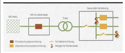
**Bild 4** Primärschutz und Kurzschluss an der Sammelschiene der Sekundärverteilung oder in einem Abgang ohne Kurzschlussschutzeinrichtung.
