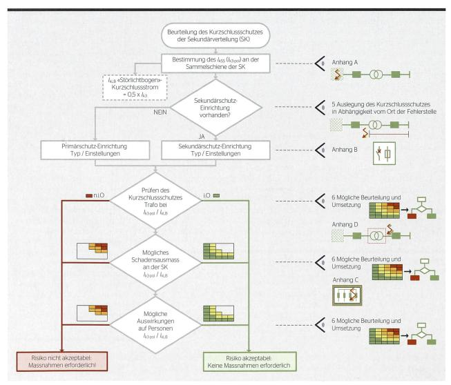
Bild 6 Flussdiagramm zur Beurteilung des Kurzschlussschutzes.
