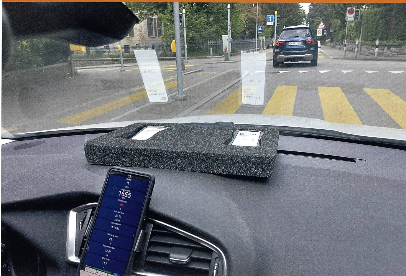
Messung unter der Frontscheibe links (Niederfrequenz) und rechts (Hochfrequenz).
