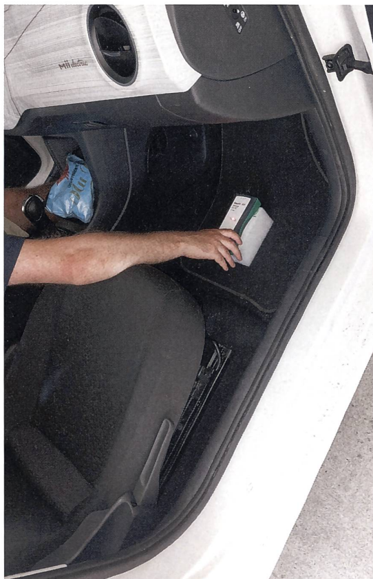
Messung im Fussraum vorne rechts. Die Messungen wurden in drei Abständen mit Distanzhaltern durchgeführt.
