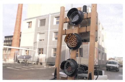
Figure 2 Feu de signalisation équipé de la RSU (boîte grise derrière le feu).
