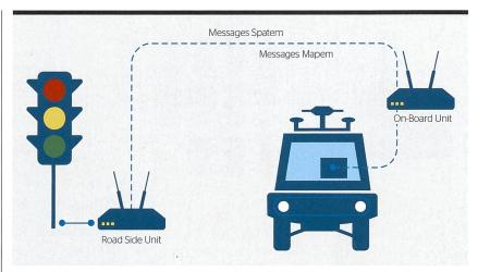
**Figure 1** L'écosystème ITS-G5: la RSU (Road Side Unit) reliée au feu de signalisation transmet des messages Spatem, relatifs à l'état du feu, et Mapem, relatifs à sa localisation, à l'OBU (On-Board Unit) embarquée dans le véhicule.
